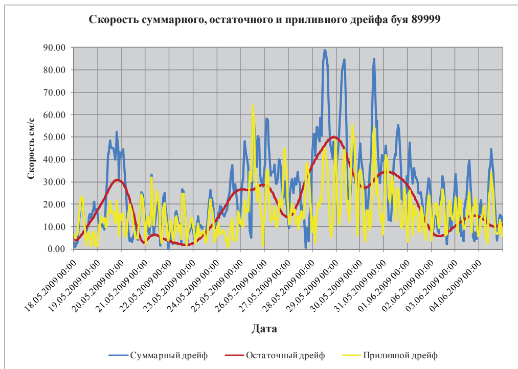
Рис. 5. Графики скорости исходного и расчетных остаточного и приливного рядов буя 89999
