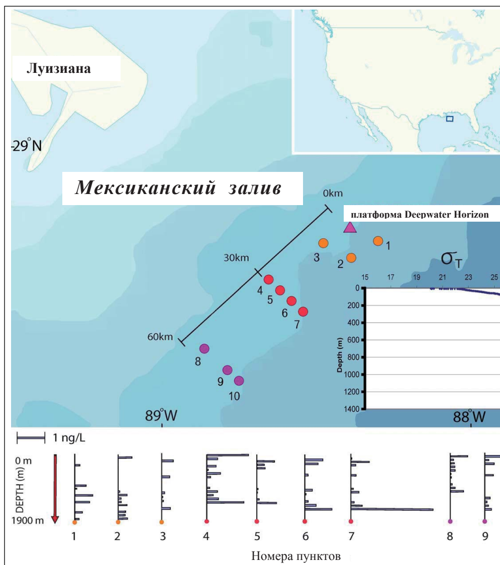
Рис. Места размещения станций забора проб рядом с платформой Deepwater Horizon, концентрация нефтяного эквивалента, определенная на основании измерений дибензотиофенов в ПМФ на указанных глубинах размещения станций, и поперечный разрез толщи морской воды, указывающий на наличие пикноклина в 100 м от водной поверхности
