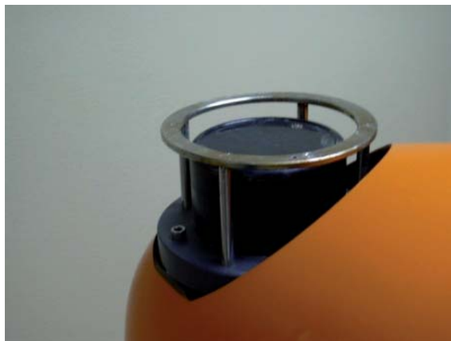
Рис. 3. Трансдюсер акустического модема Benthos ATM585, смонтированный в верхней части зонда-профилографа «Аквалог»
