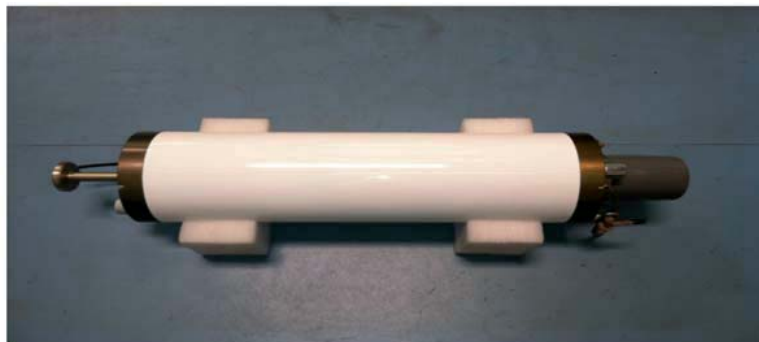
Рис. 3. Регистратор давления на дне (BPR)
